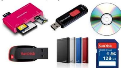
**Periféricos de almacenamiento:** Sirven para almacenar datos. Ejemplos: unidad de disco duro (HDD), unidad de estado sólido (SSD), pendrive, disco compacto (CD), disco versátil digital (DVD) y disco duro portátil.
